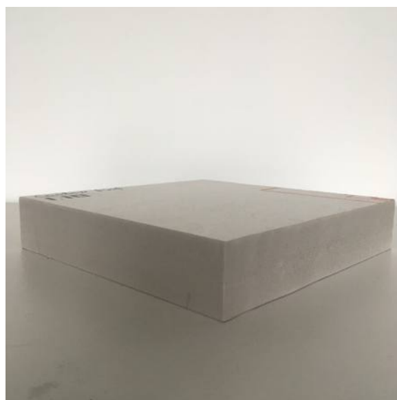
Рис. 3 Контрольные образцы ТЕХНОНИКОЛЬ CARBON PROF
