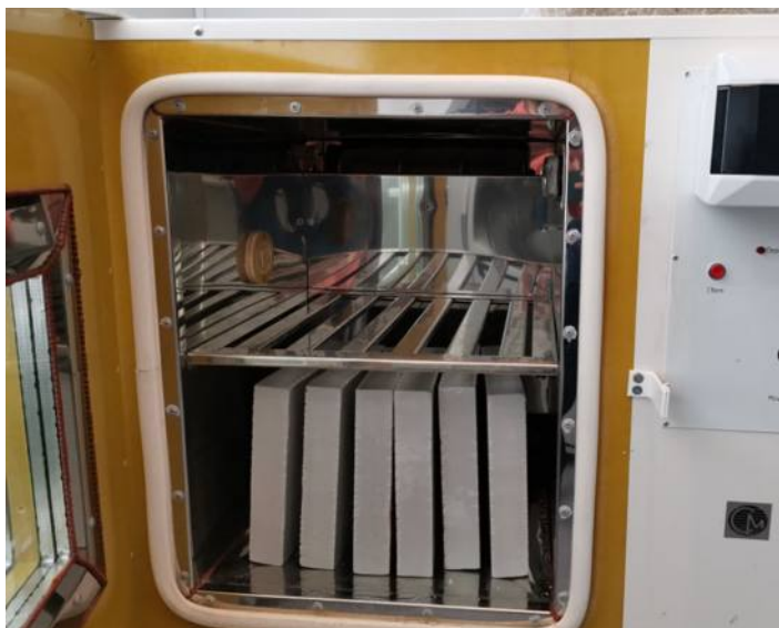
Рис. 2 Образцы в климатической камере в процессе испытаний
