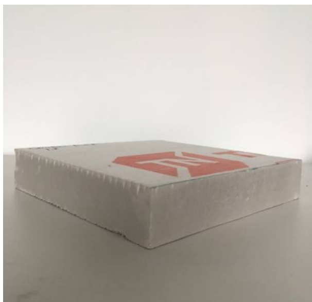
Рис. 7 Опытные образцы ТЕХНОНИКОЛЬ CARBON PROF после испытаний
